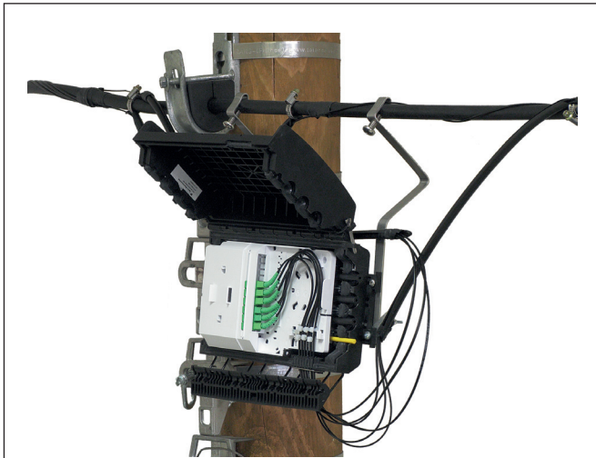
Рис.14. Отводная муфта FDC, подвешиваемая на несущий трос. Навивные кабели защищены ЗПТ 10 мм на участке муфта-трос
